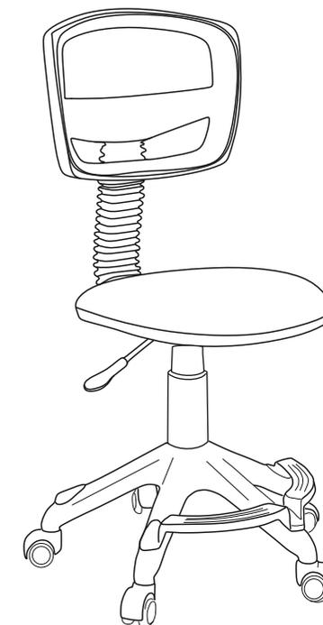
**Примечания:** Шаг 2. Снять защитный колпачок с газлифта, в случае его наличия.
