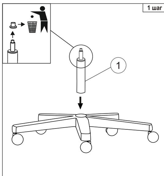
Примечание: Снять защитный колпачок с газлифта (при наличии).
