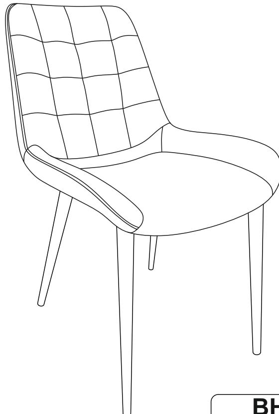
Примечание: Шаг. 1 Рекомендуется соблюдать порядок сборки ножек, показанный цифрами I, II, III. Допускается зазор между ножкой стула и полом до 3 мм. При отклонении более 3 мм рекомендуется установить регулировочную шайбу под одно из крайних крепежных отверстий со стороны ножки, имеющей зазор.
