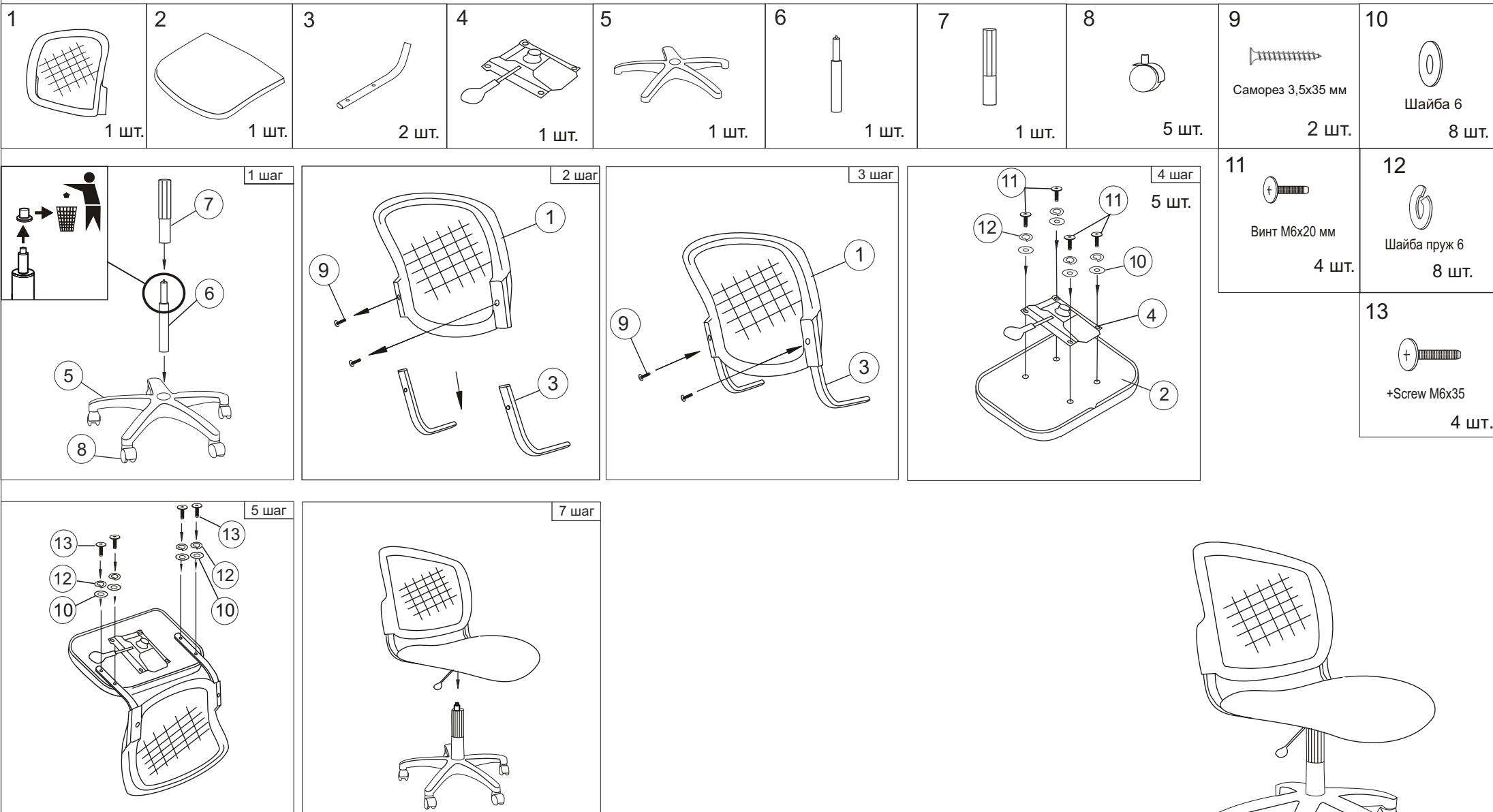
Примечания: Шаг 1. Снять защитный колпачок с газлифта, в случае его наличия.
