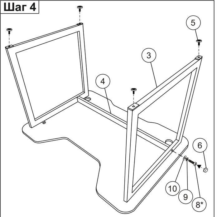
**Примечание:** Шаг 2-3. Не прикладывать усилия к боковинам подстоля во время сборки. Это может привести к поломке столешницы. Шаг 2, 4. \*Винт 8 необходимо затянуть до упора.
