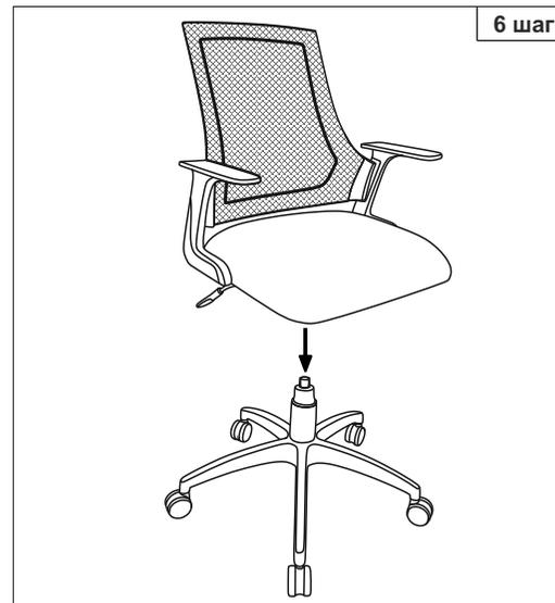
**Примечания:** Шаг 1. Снять защитный колпачок с газлифта, в случае его наличия.
