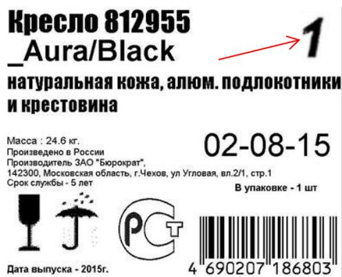
Данная маркировка позволяет выявлять и применять меры к конкретным виновникам появления бракованной продукции непосредственно в процессе производства.
