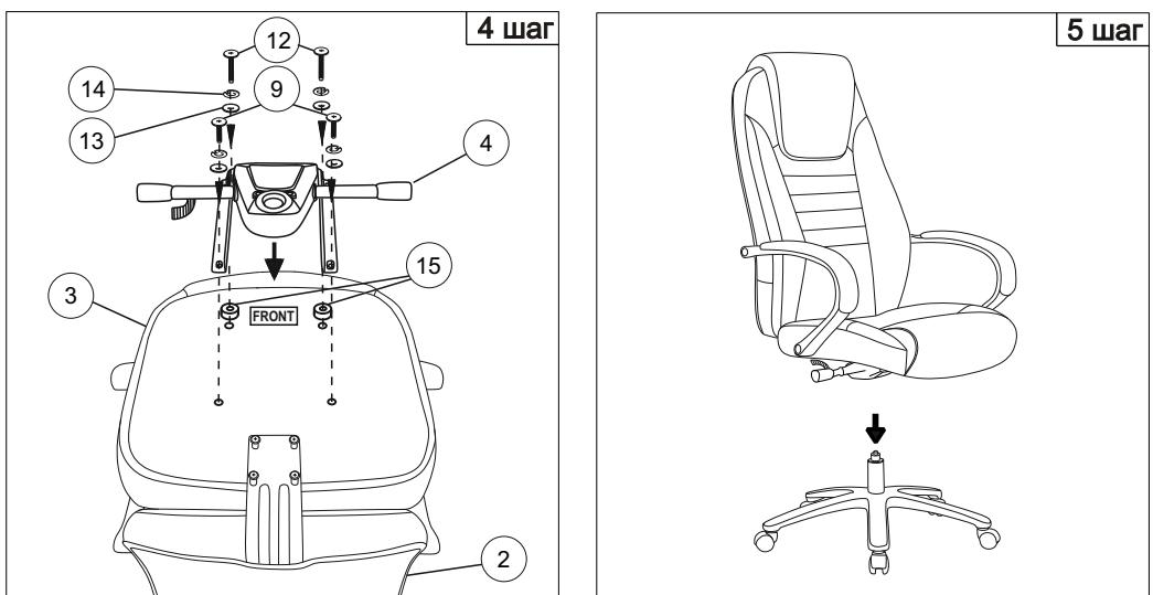
**Примечания.** Шаг 1. Снять защитный колпачок с газлифта, в случае его наличия. Шаг 2 - 3. Вставить и закрутить винты поочерёдно, не затягивая их до конца. После выполнения шага 3 закрутить все винты до полной фиксации.
