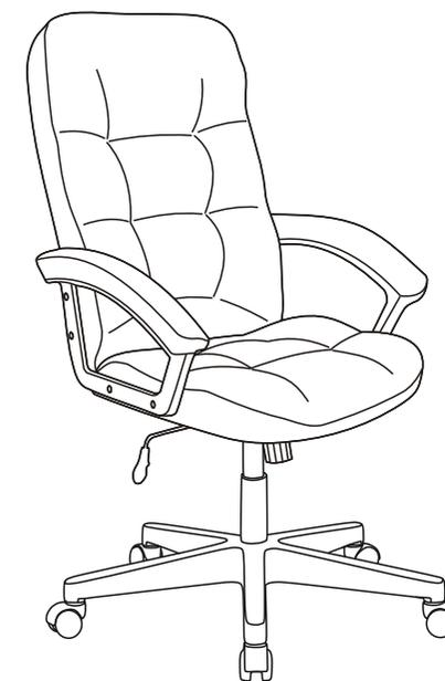
**Примечание:** Шаг 1. Снять защитный колпачок с газлифта, в случае его наличия. Шаг 3-4: Вставить и закрутить винты поочередно, не затягивая их до конца. После выполнения шага 4 закрутить все винты до полной фиксации. Молния чехла спинки используется исключительно в процессе производства. Попытка снять чехол самостоятельно может привести к поломке.
